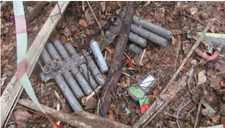
Raketenpaket Schleudersitz und Notsignal
