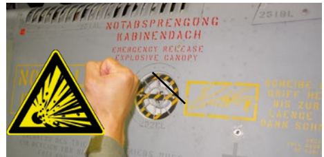
Absprengen des Kabinendaches (CANOPY JETTISON)
