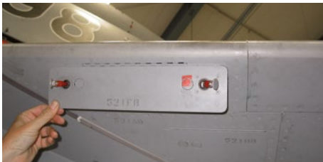
Öffnen des Kabinendaches
