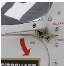
Öffnen der Cockpittüren (rechts u. links)
